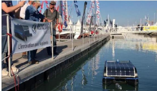
Document 10 : Photographie du petit robot Geneseas , collectant les déchets à la surface de l'eau, dans le port de La Rochelle. (Source : https://plastics-themaq.com/Recyclamer-the-aquatic-vacuum )
